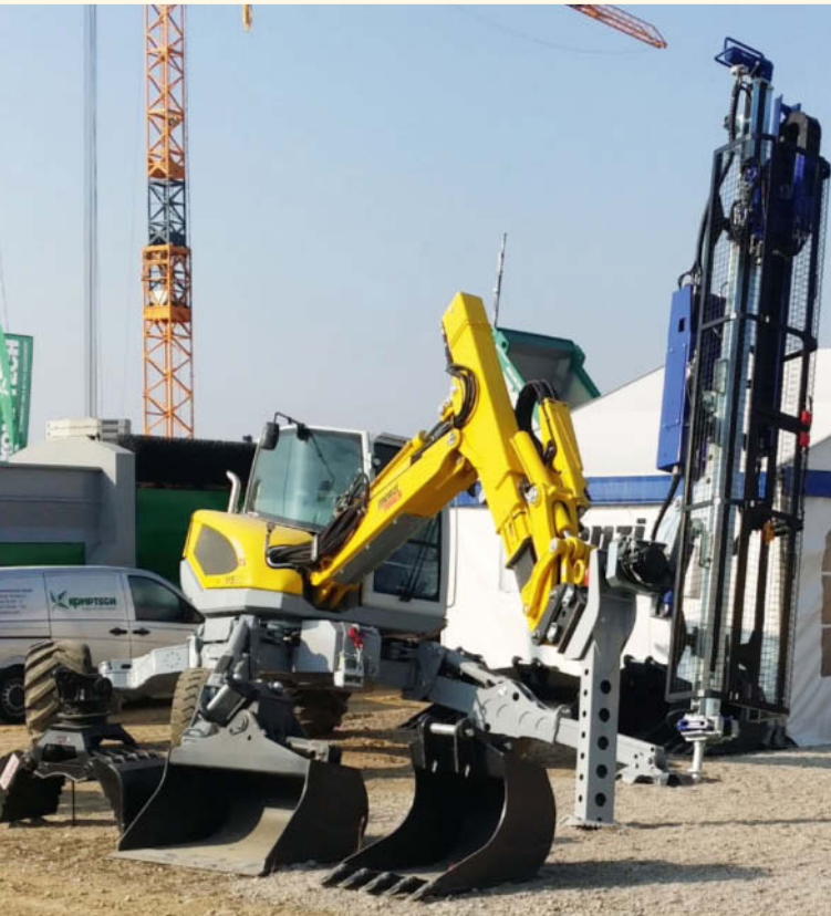
Anbaulafette TMF10K, aufgebaut auf einem Menzi Muck Schreitbagger.
