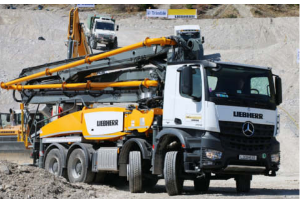
Vielältige Lösungen zur wirtschaftlichen Herstellung, zum optimalen Transport und zur idealen Ausbringung von Qualitätsbeton: Fahrmischer und Autobetonpumpe sind auf Fahrgestellen von Mercedes-Benz montiert.
