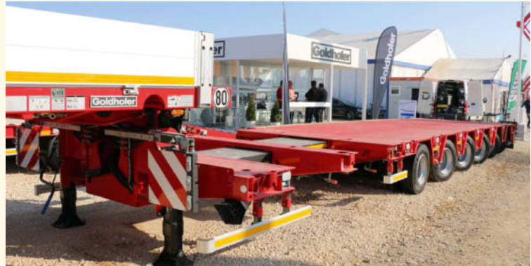
Der Goldhofer Sechssacher MPA 6 AA Sattelanhänger mit einer Nutzlast von 76 t sowie seiner niedrigen Ladehöhe von 780 mm im Blockmaß zog einige interessierte Blicke auf sich.
