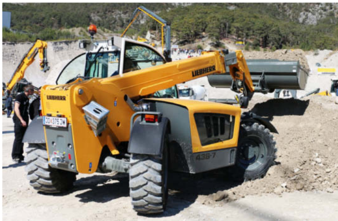
Die neuen Liebherr-Teleskopklader mit Hubhöhen von 7 Metern wurden insbesondere für Unternehmen der Bauindustrie und der Vermietung entwickelt. Im Bild ein TL 436-7.
