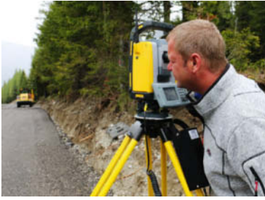
Das aktive Prisma MT 900 auf dem Grader gleicht 20 Mal in der Sekunde die Parameter des Graders mit dem Tachymeter SPS 930 ab.
