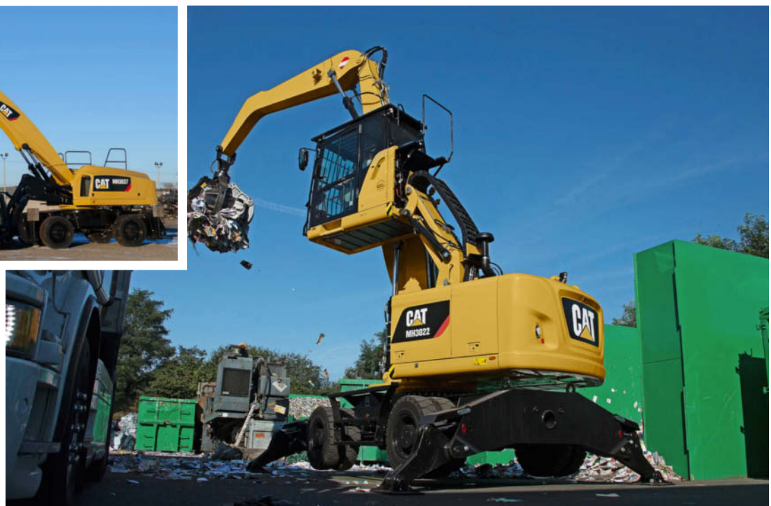
Oben der neue 40-Tonnen-Materialumschlagbagger Cat MH3037 mit komfortablem Zugang auf Bodenebene.
