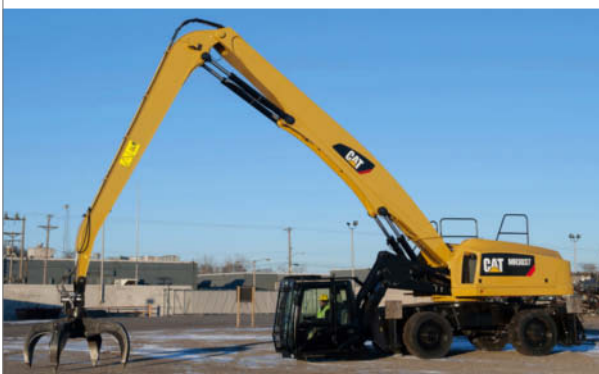
Oben der neue 40-Tonnen-Materialumschlagbagger Cat MH3037 mit komfortablem Zugang auf Bodenebene.
