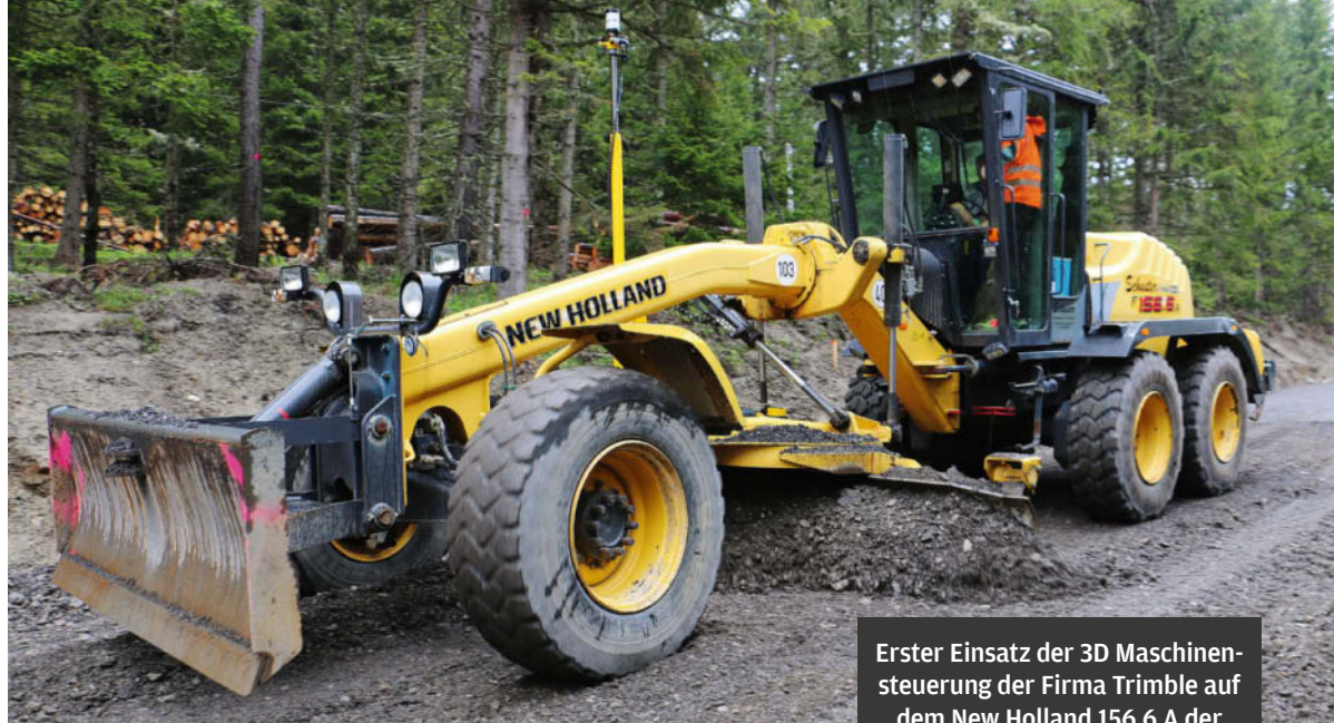
Das aktive Prisma MT 900 auf dem Grader gleicht 20 Mal in der Sekunde die Parameter des Graders mit dem Tachymeter SPS 930 ab.
